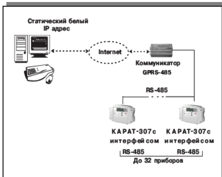
Рисунок 1.9 — Организация канала связи в режиме GPRS вариант 2
