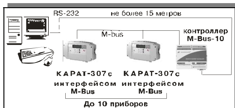
Рисунок 1.5 — Вариант применения интерфейса M-Bus с контроллером M-Bus-10
