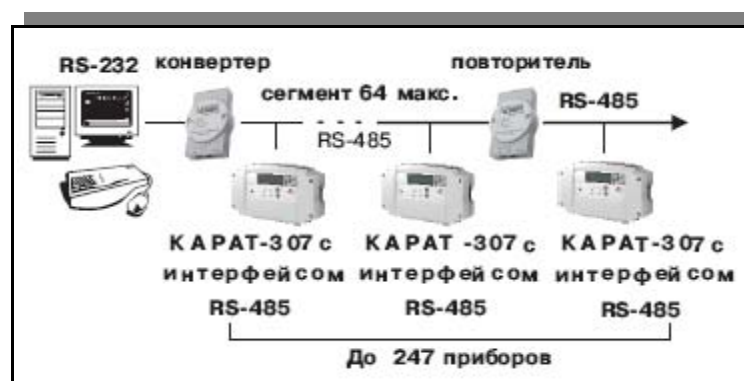
Рисунок 1.4 — Вариант применение интерфейса RS-485
