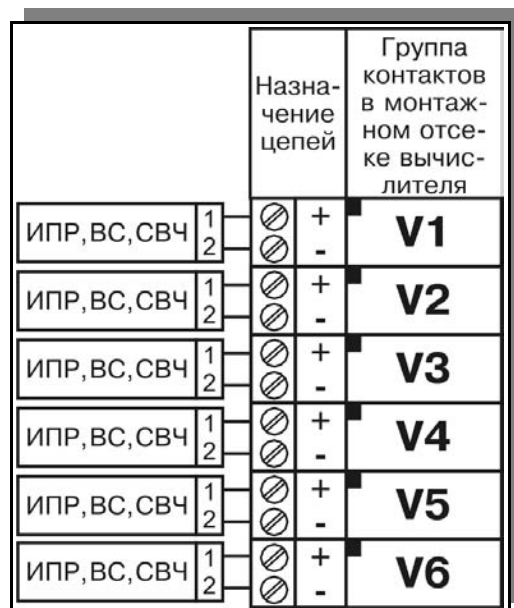
Рисунок Б.1 — Схема подключения ИПРВ, ВС и СВЧ к вычислителю КАРАТ-307.
