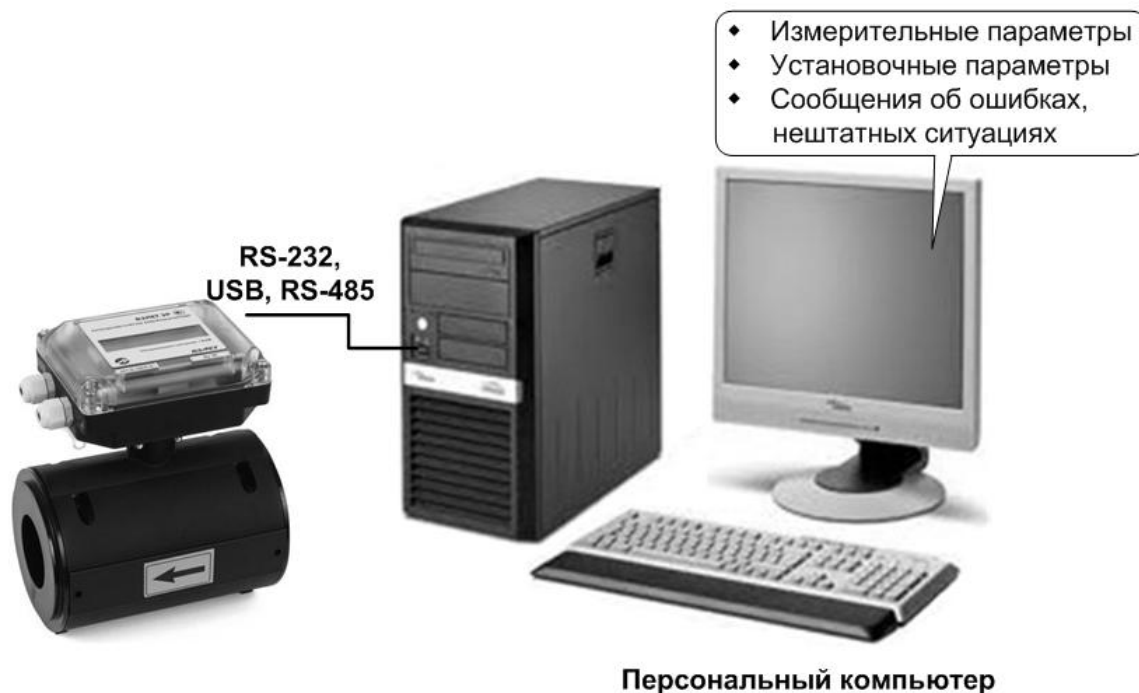
Рис.1. Средства управления расходомером ВЗЛЕТ ЭР.
