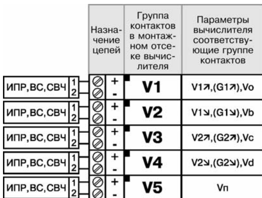
Рисунок В.1 – Схема подключения ИПР, ВС, СВЧ к вычислителю Эльф
