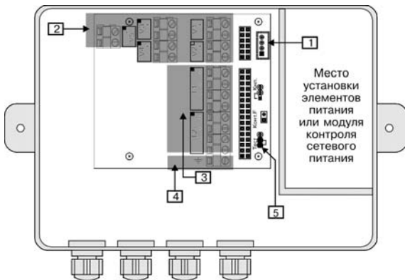
Рисунок Б.2 – Внешний вид монтажного отсека вычислителя ЭЛЬФ-02
