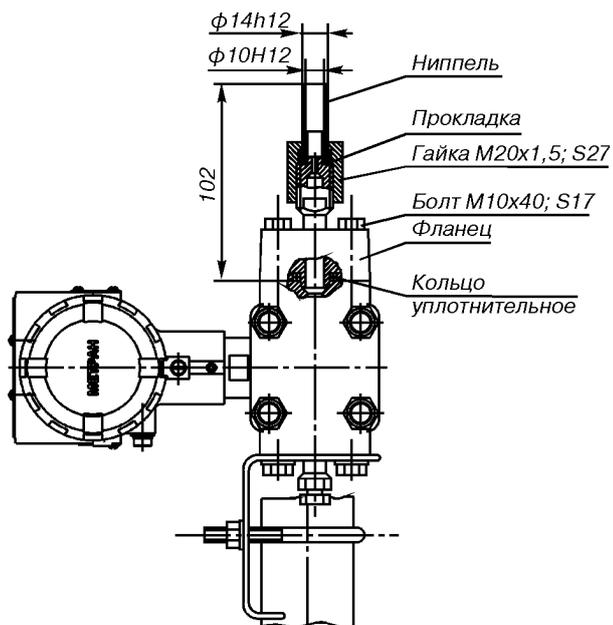
Рис.24. Датчики мод. 150CG с установленным ниппелем под накидную гайку M20x1,5 (код D5) и монтажным кронштейном для установки на трубе  $\phi 50$  мм (код B1).
