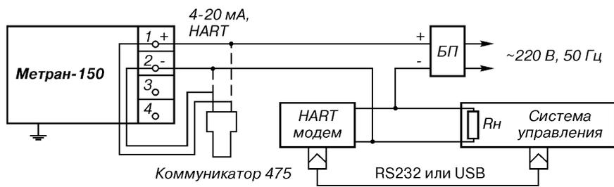
Рис.9. Вариант включения датчика с HART-модемом или HART-коммуникатором.
