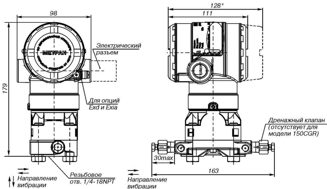
\* Размер для датчиков с кодом МА или М4 (встроенный ЖКИ).
