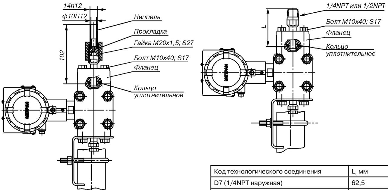
Рис. 28. Датчики мод. 150CD с установленными ниппелями под накидные гайки M20x1,5 (код D5) и монтажным кронштейном для установки на трубе ф50 мм (код B1).
