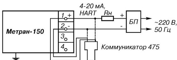
Рис. 6. Выходной сигнал 4-20 мА (2-х-проводная линия связи).
