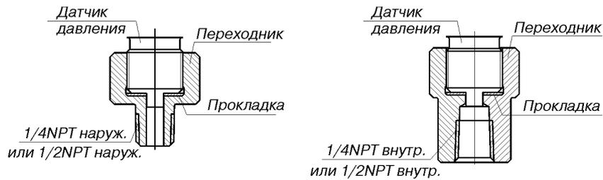
**Рис.33. Датчики мод. 150TG, ТА. Установка монтажных деталей - переходников типа 1/4NPT наружная (код 2D) или 1/2NPT наружная (код 2E) или типа 1/4NPT внутренняя (код 2A) или 1/2NPT внутренняя (код 2B).**
