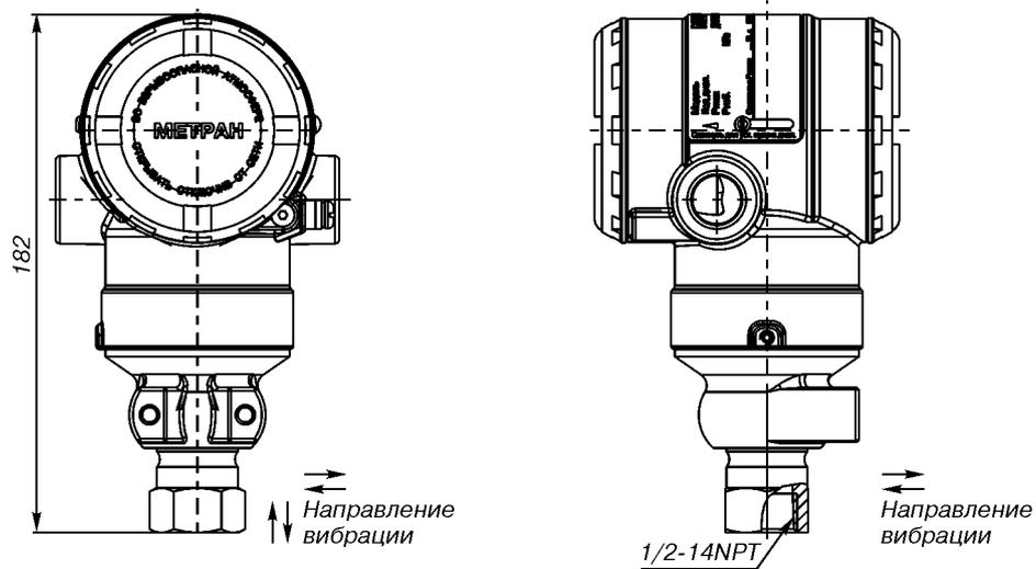
Рис.21. Датчики мод. 150TGR и 150TAR с кодом технологического соединения 2B.
