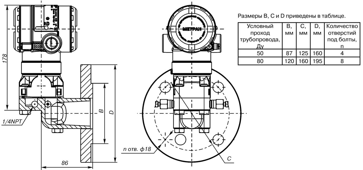
Рис. 17. Датчики мод. 150СDR с фланцем уровня (коды FE, FF)
