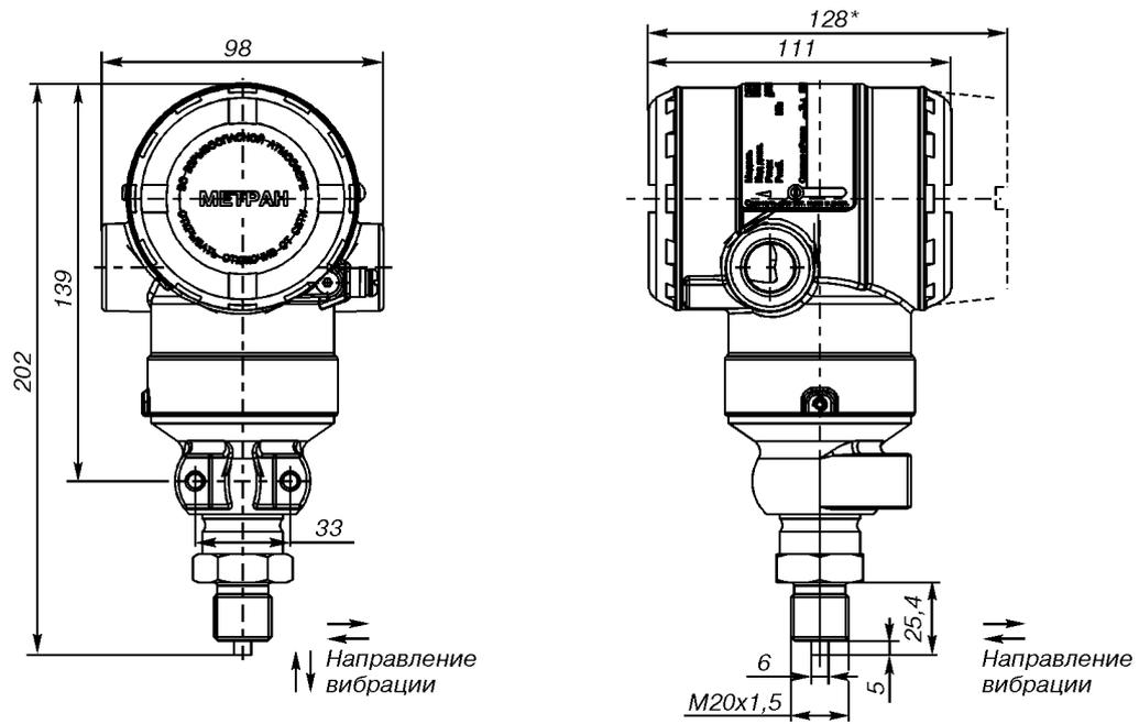
\* Размер для датчиков с кодом МА (встроенный ЖКИ).
