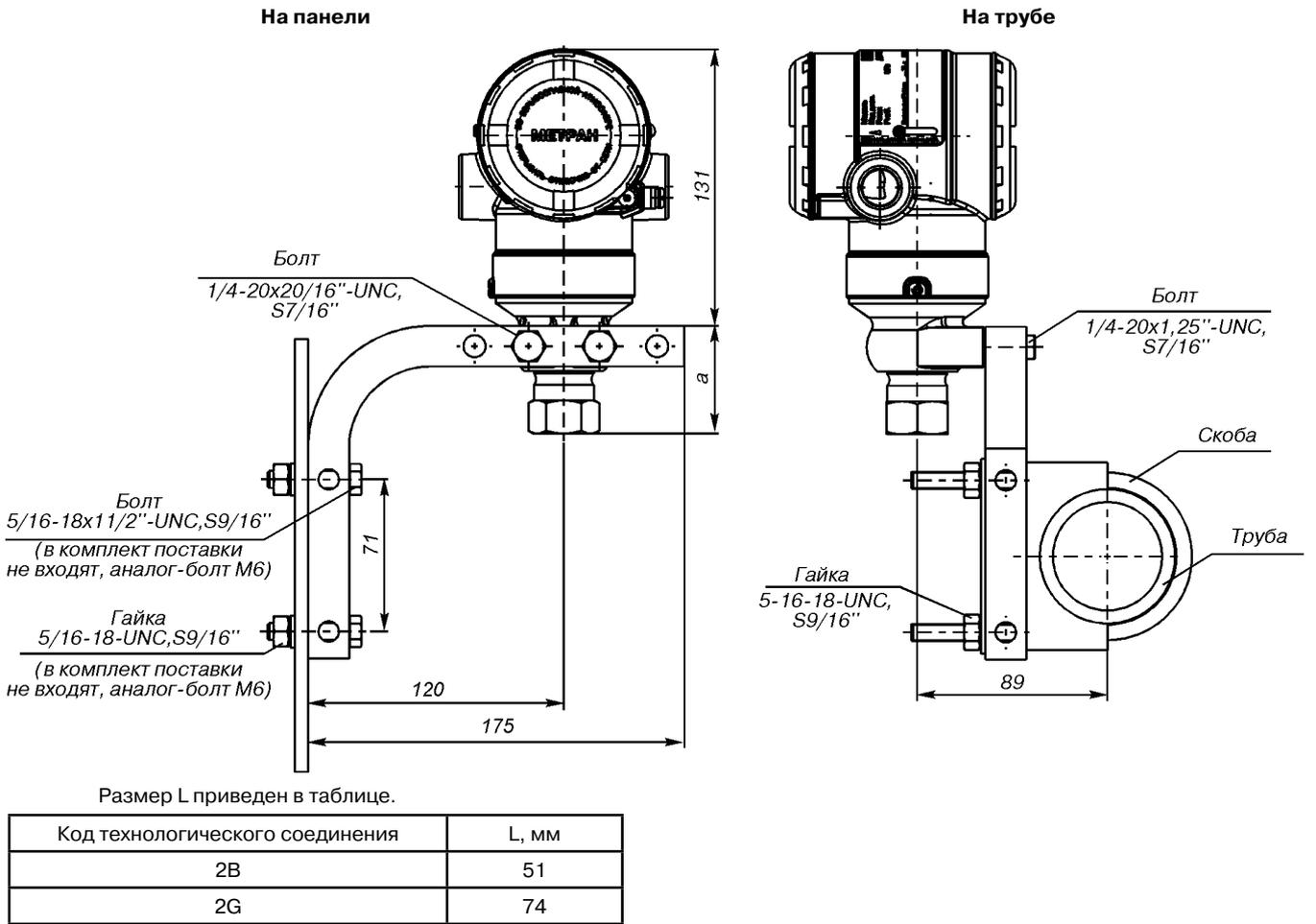
**Рис.22. Датчики мод. 150TGR и 150TAR с установленным монтажным кронштейном на панели и на трубе (код В4).**
