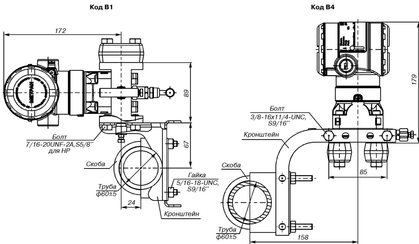
Рис. 16. Датчики мод. 150CDR и 150CGR с традиционным фланцем и монтажным кронштейном.
