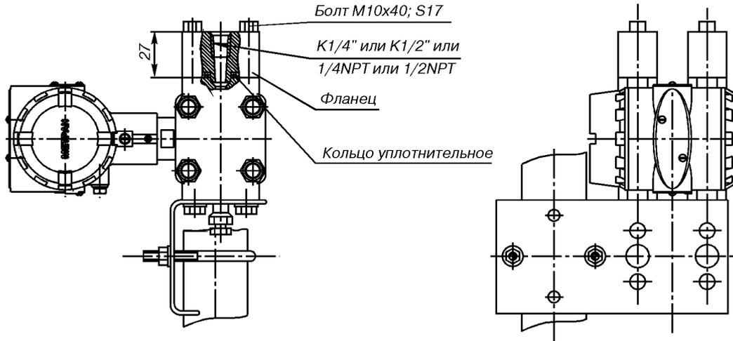
**Рис.30. Датчики мод. 150CD с установленными монтажными фланцами с резьбовым отверстием K1/4" (код D1), или K1/2" (код D2), или 1/4NPT (код D3), или 1/2NPT (код D4) и монтажным кронштейном для установки на трубе  $\phi 50$  мм (код B1).**
